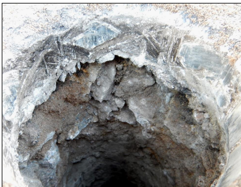
Ilustrativní foto skladby asfaltového krytu a štěrkové konstrukce v sondě S1.
