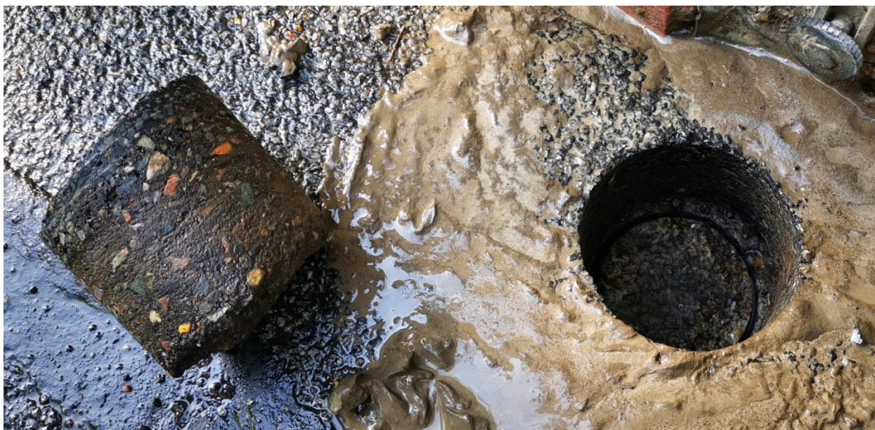
Obrázek č. 4: Jádrový vývrt 02-V5 pro zjištění skladby vozovkového souvrství.
