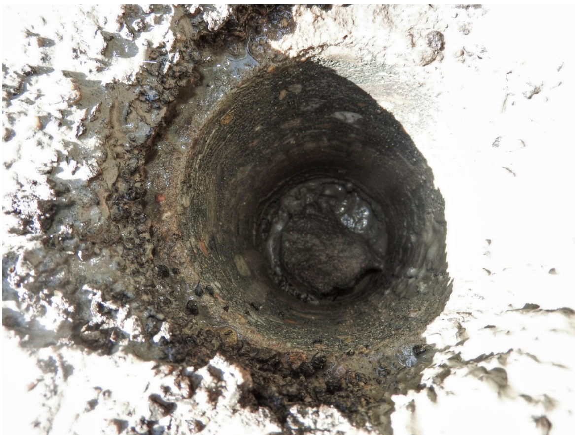
Obrázek č. 8: Detail vrtu 04-V5 po odvrtání – asfaltový beton a betonová vrstva.
