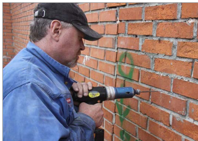
foto 48: Nedestruktivní ověřování pevnosti cihelného zdiva
