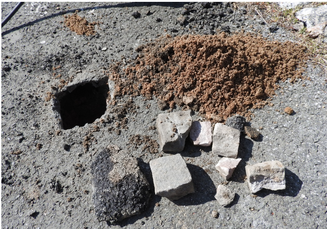
Obrázek č. 6: Sonda V3 pro zjištění skladby chodníku (mostního svršku).
