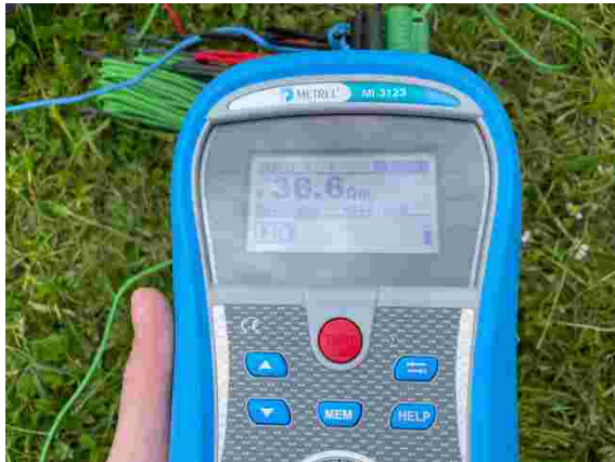
Obr. 1 Měrný odpor půdy do hloubky 1,5 m
