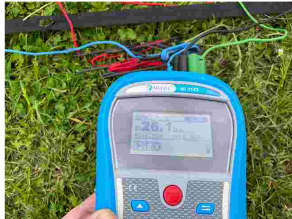
Obr. 2 Měrný odpor půdy do hloubky 5 m
