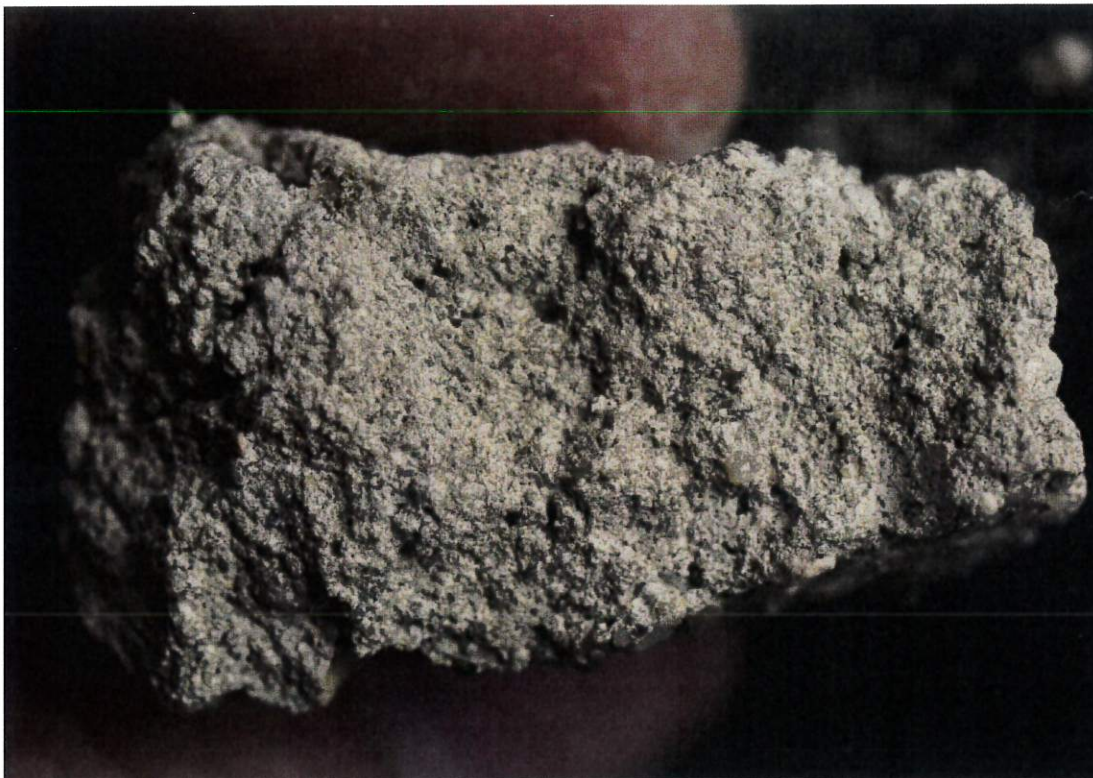
Obrázek 6: Vzorek 2, lomová plocha malty
