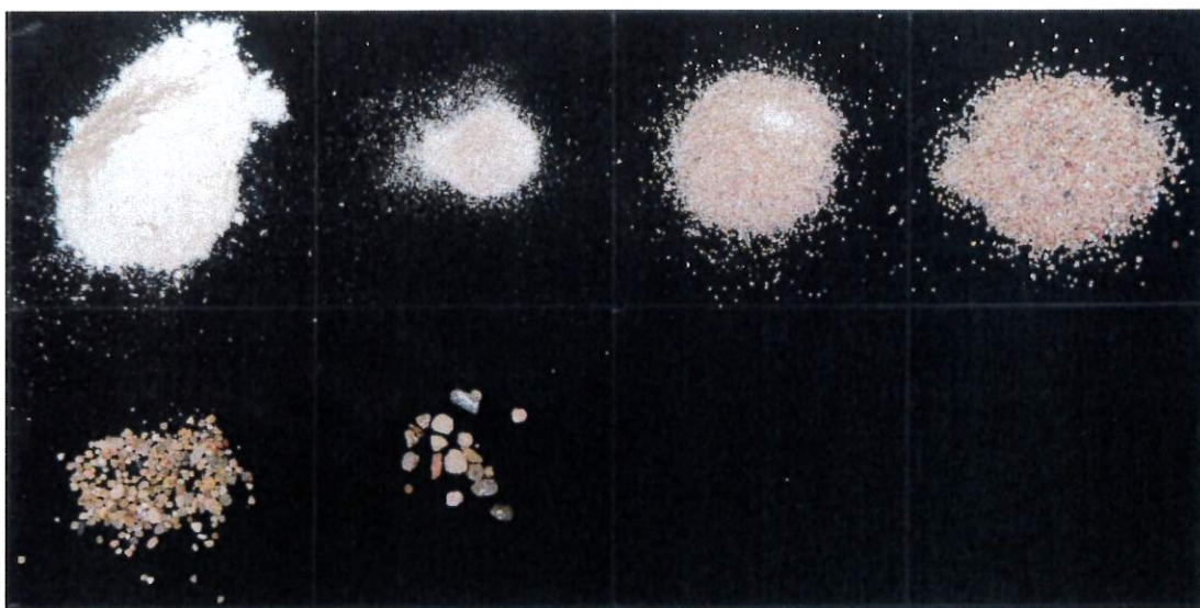
Obrázek 7: Vzorek 1, frakce kameniva, zleva nahoře <0,125 ; 0,125-0,25 ; 0,25-0,5 ; 0,5-1 ; 1-2 ; 2-4 ; 4-8 a > 8 mm
