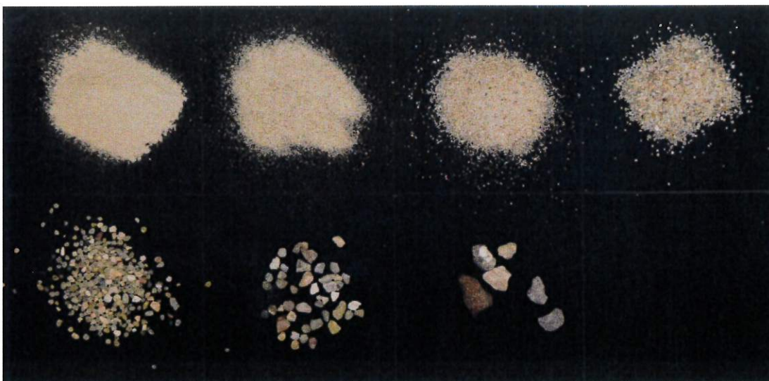
Obrázek 8: Vzorek 2, frakce kameniva, zleva nahoře <0,125 ; 0,125-0,25 ; 0,25-0,5 ; 0,5-1 ; 1-2 ; 2-4 ; 4-8 a > 8 mm
